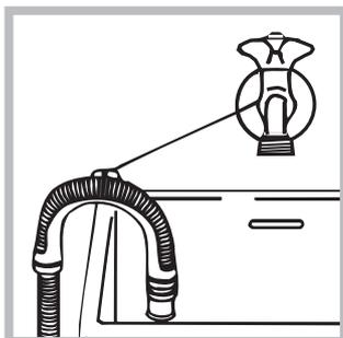
Una alternativa es apoyar el tubo de descarga en el borde de un lavamanos o de una bañera, uniendo la guía suministrada con el aparato, al grifo (ver la figura). El extremo libre del tubo de descarga no debe permanecer sumergido en el agua.
