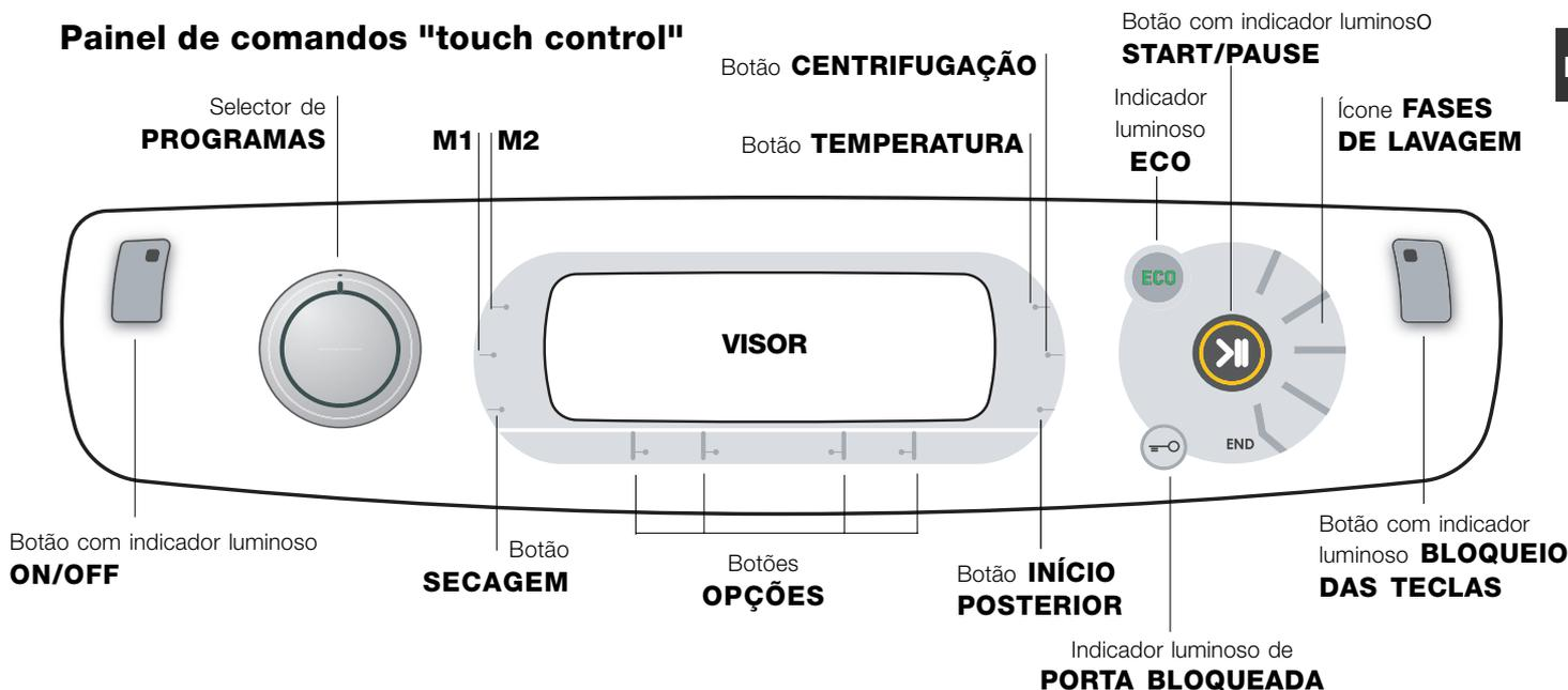
Botão com indicador luminoso **ON/OFF**: carregue brevemente no botão para ligar ou desligar a máquina. O indicador luminoso verde indica que a máquina está ligada. Para desligar a máquina durante a lavagem, é necessário manter pressionado o botão por mais tempo, aproximadamente 3 segundos; uma pressão breve ou acidental não permitirá o desligamento da máquina. O desligamento da máquina durante uma lavagem em curso anula a própria lavagem.
