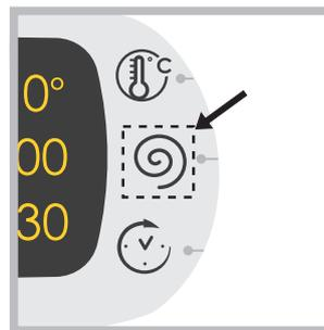
Para modificar as configurações, carregue levemente no ícone dentro da área sensível (touch control) como indicado na figura.
