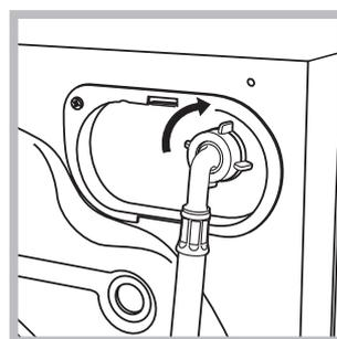
1. Ligue o tubo de alimentação na máquina atarraxado no apropriado fornecimento da água, na parte traseira, em cima à direita (veja a figura).
