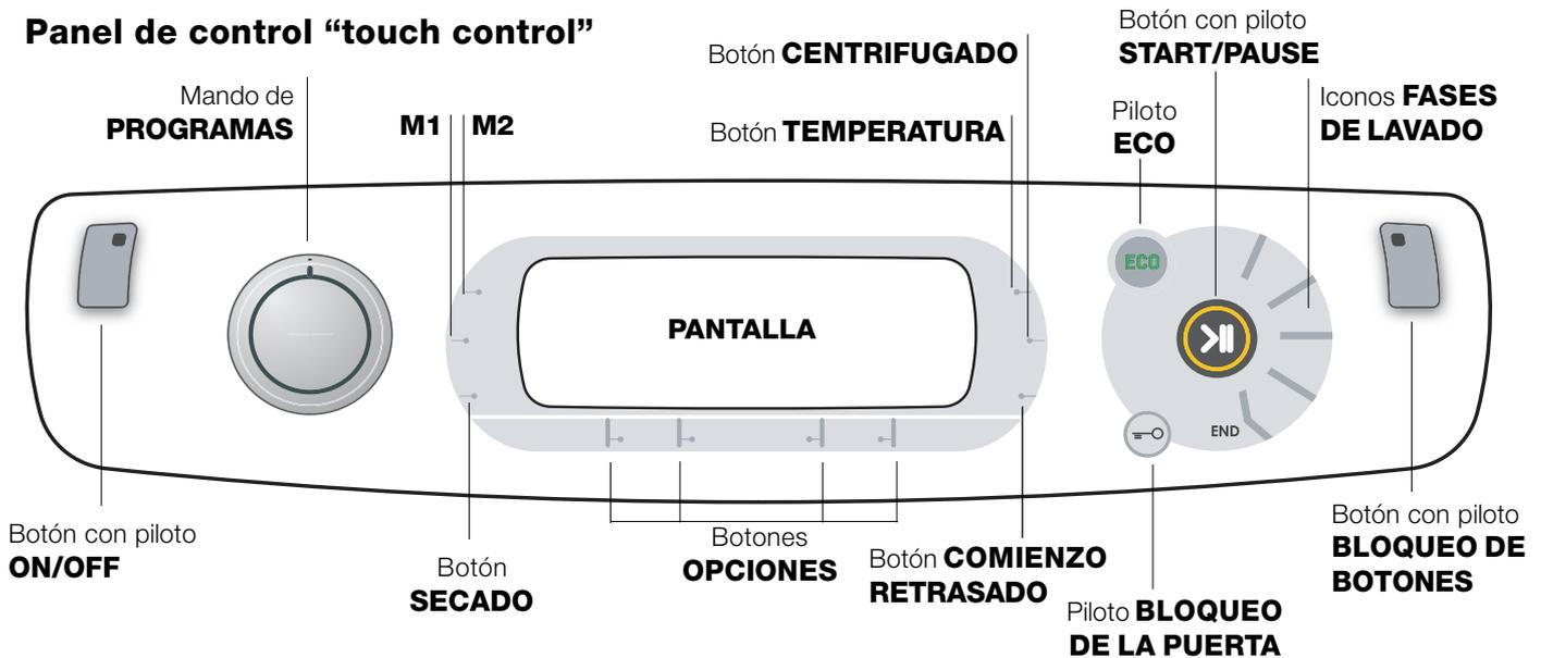
Botón con piloto **ON/OFF:** presione brevemente el botón para encender o apagar la máquina. El piloto verde indica que la máquina está encendida. Para apagar la lavasecadora durante el lavado, es necesario mantener presionado el botón durante más tiempo, aproximadamente 3 seg.; si se presiona en forma más breve o accidental, la máquina no se apagará. Si la máquina se apaga durante un lavado en curso, dicho lavado se anulará.
