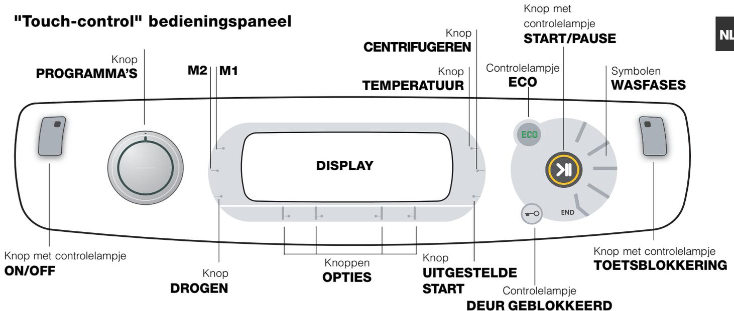
Knop met controlelampje **ON/OFF**: druk even op de knop om de Wasdroogmachine aan of uit te zetten. Het groene controlelampje geeft aan dat de Wasdroogmachine aanstaat. Om de Wasdroogmachine tijdens de wascyclus uit te zetten moet u de knop iets langer, circa 3 seconden, ingedrukt houden. Als u de kort of per ongeluk indrukt zal de Wasdroogmachine niet uitgaan. Als u de Wasdroogmachine tijdens de wascyclus uitdoet wordt de cyclus automatisch geannuleerd.
