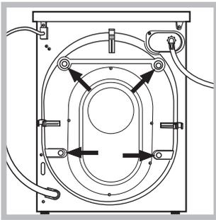
2. Quite los 4 tornillos de protección para el transporte y el correspondiente distanciador, ubicados en la parte posterior (ver la figura).
