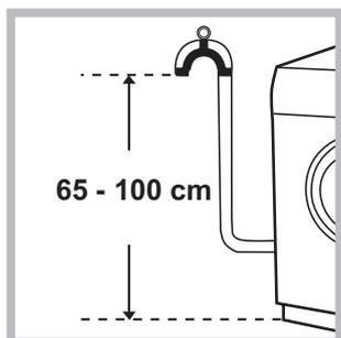
Collegare il tubo di scarico a una condotta di scarico o a uno scarico a muro posti tra 65 e 100 cm da terra evitando assolutamente di piegarlo.
