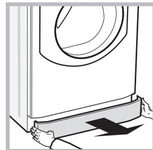
1. verwijder het afdekpaneel aan de voorzijde van de wasautomaat door er op het midden op te drukken. Duw beide zijken naar beneden toe en verwijder het paneel (zie afbeeldingen).
