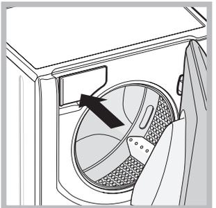
Het wasmiddelbakje bevindt zich aan de binnenkant van de automaat en verschijnt als u de deur opent. Voor de dosering van wasmiddelen zie het hoofdstuk "Wasmiddelen en wasgoed".
