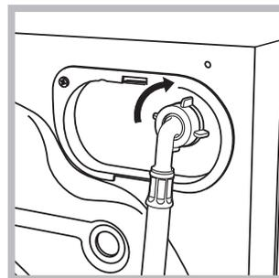
1. Verbind de watertoevoerslang aan de Wasdroogmachine door hem met de haakse aansluiting op de betreffende watertoevoer te schroeven, rechtsboven aan de achterkant (zie afbeelding).
