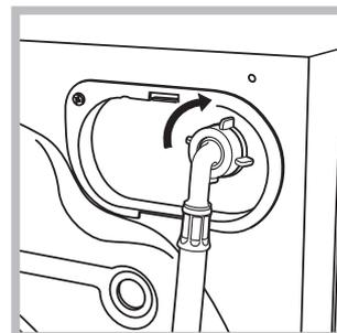
2. Conecte el tubo de alimentación a la lavasecadora enroscándolo en la toma de agua correspondiente ubicada en la parte posterior arriba y a la derecha (véase la figura).
