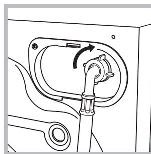
2. Schließen Sie das andere Ende des Schlauches an den oben rechts am Rückteil des Wäschetrockners befindlichen Wasseranschluss an (siehe Abbildung).
