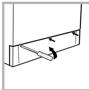
1. verwijder het paneeltje aan de voorkant van de wasdroogmachine met behulp van een schroevendraaier (zie afbeelding);
