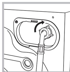
2. Raccordez le tuyau d'alimentation au lavante-séchante en le vissant à la prise d'eau prévue, dans la partie arrière en haut à droite (voir figure).
