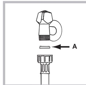
1. Plaats de pakking A op het uiteinde van de waterslang en schroef hem op een koudwaterkraan met een mondstuk met schroefdraad van 3/4 gas (zie afbeelding). Voordat u hem aansluit moet u het water laten lopen totdat het helder is.
