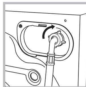
2. Verbind de slang aan de wasdroogmachine door hem op de betreffende watertoevoer aan te schroeven, rechtsboven aan de achterkant (zie afbeelding).
