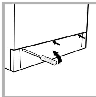
1. démontez le panneau situé à l'avant du lavante-séchante à l'aide d'un tournevis (voir figure);
